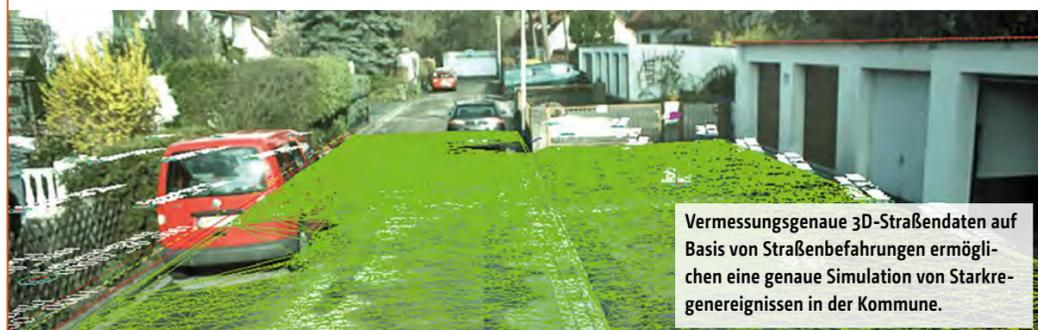
Vermessungsgenaue 3D-Straßendaten auf Basis von Straßebefahrungen ermöglichen eine genaue Simulation von Starkregenereignissen in der Kommune.
